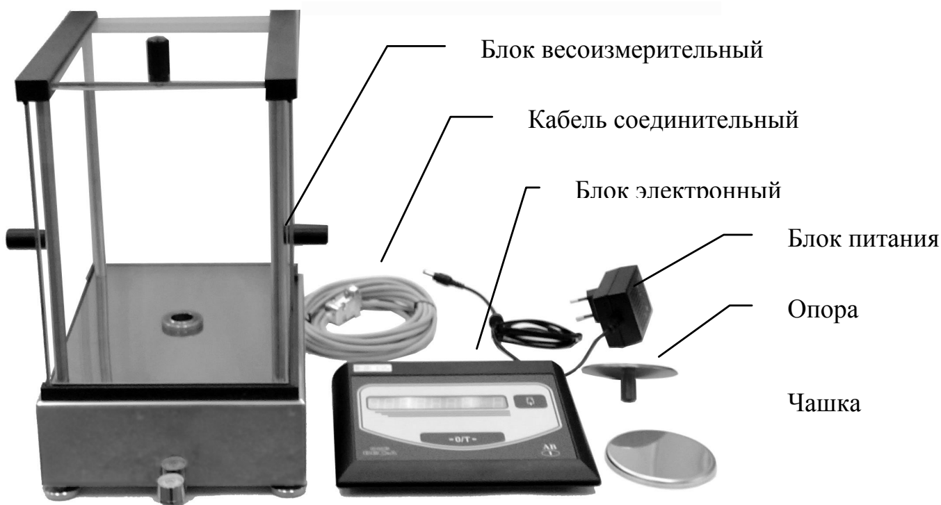
Рисунок 4 – Блоки и детали весов
