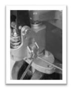
11 Прокачайте рычаг несколь-ко раз для подъема вил. Установите рычаг подъема/ опускания в НЕЙТРАЛЬНОЕ положение. Используя 14 ммгаечный ключ и плоскую отвертку, отрегулируйте кулачок клапана так, чтобы вилы на опускались или поднимались (если ручка нажата) в данном положении.
