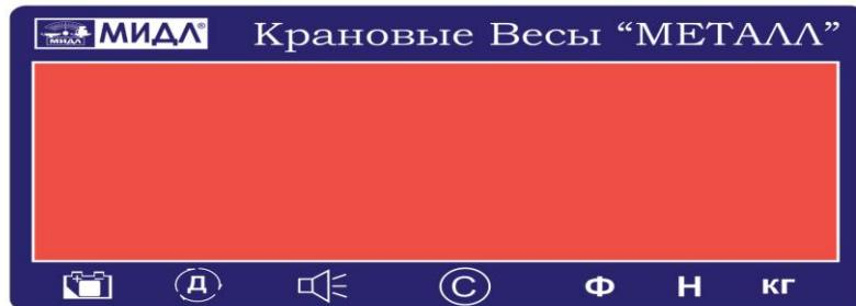
**LCD дисплей (соответствует LED, за исключением того, что символика располагается на экране дисплея):**
