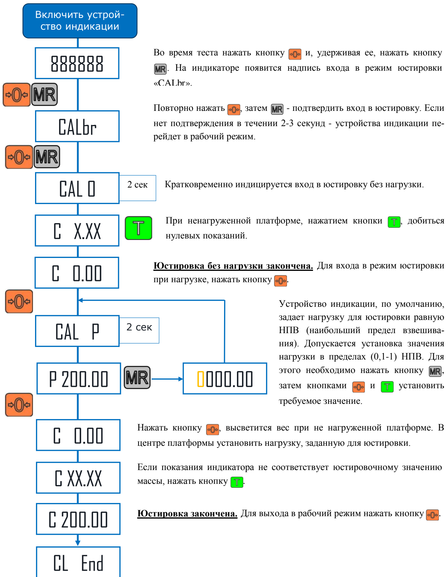
Рис. 17.1. Порядок проведения юстировки
